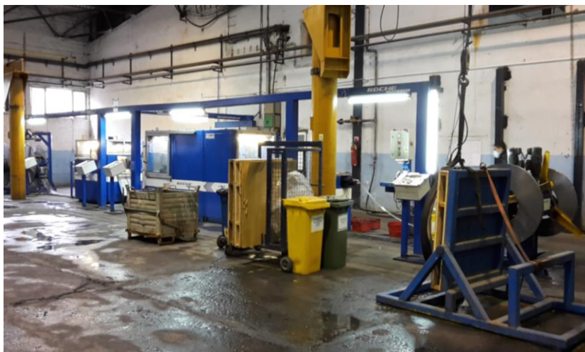
Слика 9 Машина за лиење на решетки
